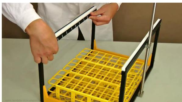
**Figure 3.2-1** Placer la bande de codage la plus longue et étroite (axe Y) sur la partie interne du côté gauche sur le châssis, juste en dessous du rail comme sur la photo. La première ligne doit se trouver à environ 10 cm du bord avant du châssis
