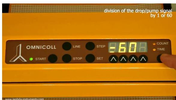
**Figure 3.4-11** Les termes "div." puis "01" ou "60" apparaissent sur l'affichage.
