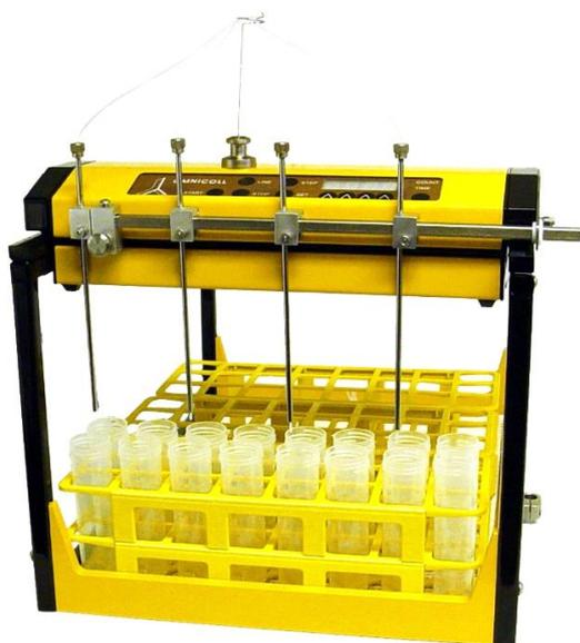
**Figure 3.8-1** Exemple prise de 4x2 fractions à l'aide d'un système à 4 canaux
