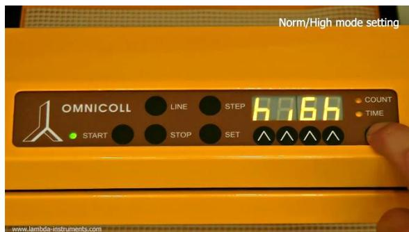
**Figure 3.7-2** Utiliser le bouton **COUNT/TIME** pour sélectionner le mode "high".
