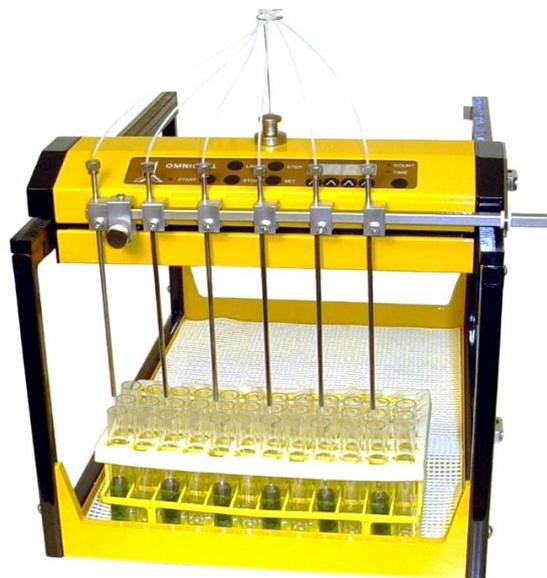
**Figure 3.8-2** Exemple prise de 6x2 fractions à l'aide d'un système à 6 canaux
