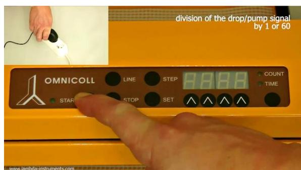
**Figure 3.4-10** Connecter l'alimentation électrique tout en appuyant sur le bouton **START**.
