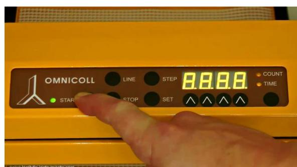
**Figure 3.6-6** Presser le bouton **START** sur le collecteur pour démarrer la prise d'échantillons. Si le tuyau n'était pas entièrement rempli au démarrage prendre une deuxième fraction.
