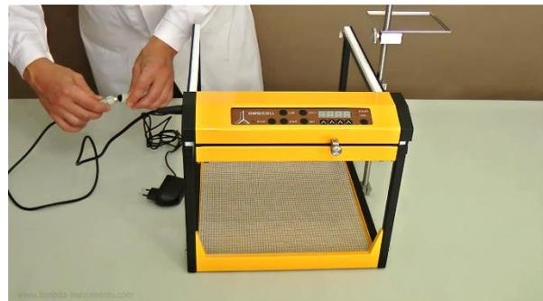
**Figure 1.1-10** Connecter le câble du collecteur de fractions OMNICOLL avec le câble de l'alimentation.
