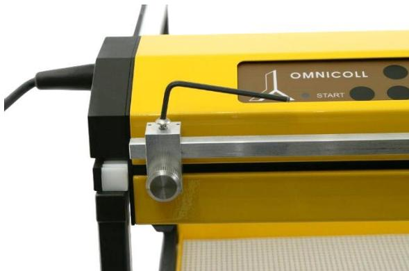
**Figure 3.8-8** Fixer le support de la barre à l'aide de la vis et la barre dans le support à l'aide de la clé à 6 pans.
