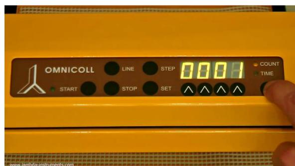
**Figure 3.6-2** Sélectionner le mode COUNT à l'aide du bouton **COUNT/TIME** (la led COUNT s'allume)
