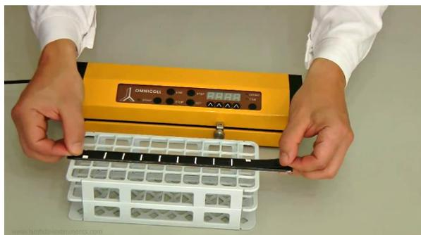
**Figure 3.2-3** Placer la bande de codage magnétique courte et large dans son support (axe X).
