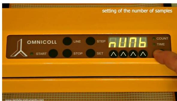
**Figure 3.7-7** Sélection du paramètre **NUMBER**, nombre de fractions à prendre.
