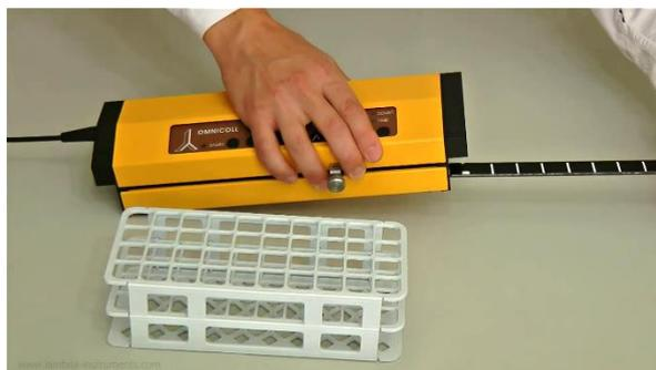
**Figure 3.2-4** Insérer le support avec sa bande de codage (axe X) dans la fente de l'unité de commande de façon à ce que les traits blancs se trouvent vers le haut
