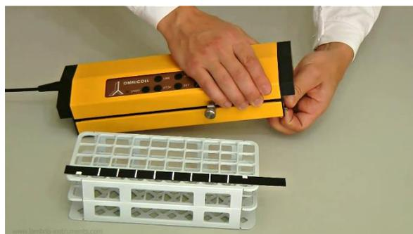
**Figure 3.3-4** Placer la bande de codage X dans son support et insérer celui-ci dans la fente prévue de l'unité de commande de sorte que les marques soient tournées vers le haut.
