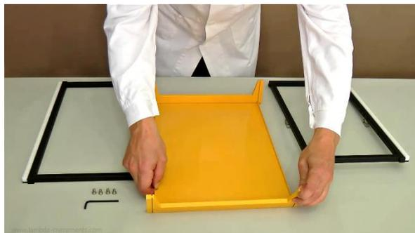
**Figure 1.1-2** Insérer le fond jaune dans la fente du deuxième montant latéral.
