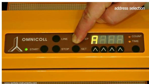
**Figure 3.4-15** Il apparaît la lettre "A" suivie de 2 chiffres sur l'affichage. Le nombre entre **00** et **99** correspond à l'adresse du collecteur de fractions.
