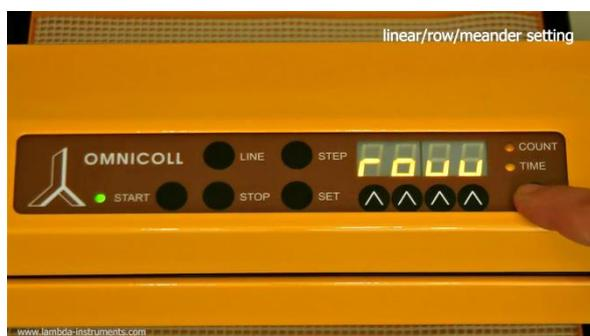
**Figure 3.4-2** Le terme "*roua*" (ros) apparaît sur l'écran, correspondant au mode par rangées. Utiliser le bouton **SELECTION** (sous les Leeds COUNT / TIME) pour sélectionner le mode de déplacement.
