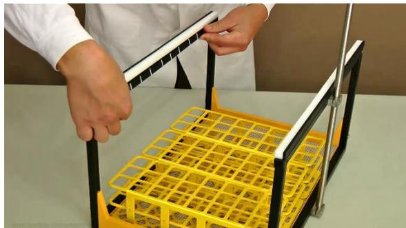
**Figure 3.3-6** Placer la bande de codage sur le côté interne du châssis juste sous le rail.
