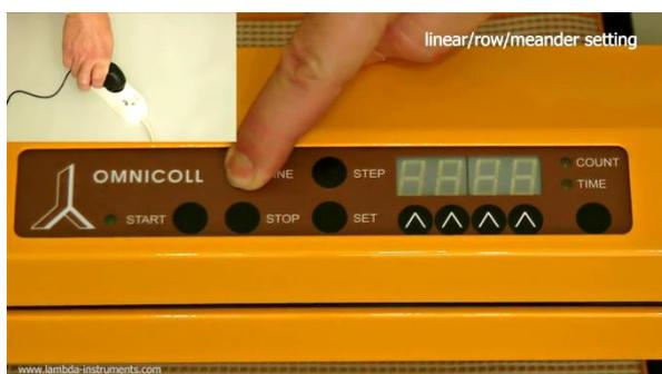
**Figure 3.4-1** Connecter l'alimentation électrique tout en appuyant sur le bouton **LINE**.
