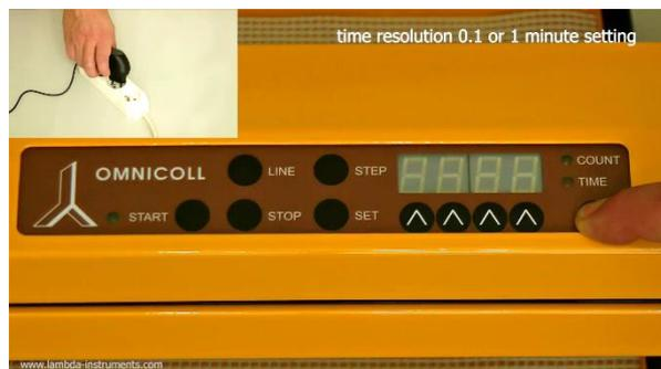
**Figure 3.4-6** Connecter l'alimentation électrique tout en appuyant sur le bouton **COUNT/TIME**.
