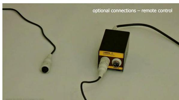
**Figure 3.6-1** Connecter le câble de commande de la pompe péristaltique au module de communication.
