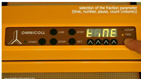
**Figure 3.7-5** Sélection du paramètre **TIME**, durée de prise de la fraction.
