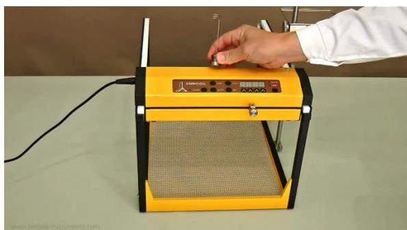
**Figure 1.2-1** Placer le support de tuyau au milieu de l'unité de commande.
