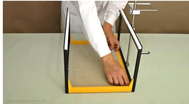
**Figure 1.1-8** Placer le tapis anti-dérapant dans le fond. Au besoin nettoyer à l'aide d'un chiffon humide. Veiller ensuite à bien sécher cette partie.
