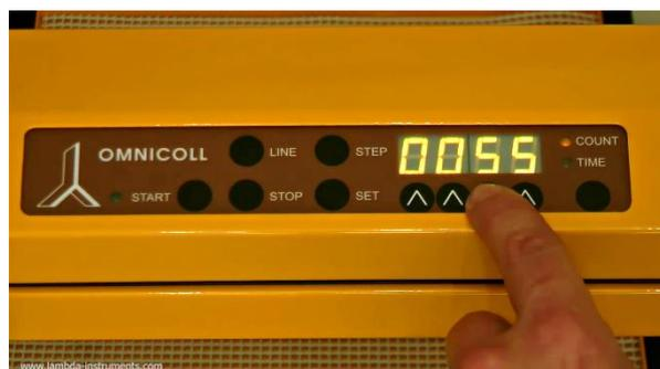
**Figure 3.6-3** Sélectionner le nombre de 'count' à l'aide des boutons  $\wedge \wedge \wedge \wedge$  sous l'affichage, par exemple: 55.
