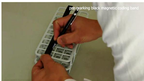
**Figure 3.3-1** Placer la bande de codage sur le portoir et marquer les positions des tubes à l'aide d'un stylo normal.
