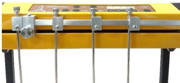
**Figure 3.8-10** Placer les guides de tuyau en face des récipients et les fixer à l'aide des vis à 6 pans.
