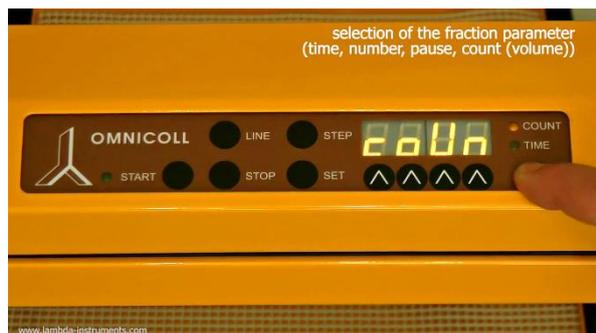
**Figure 3.7-4** Sélection du paramètre **COUNT** (volume).
