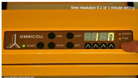
**Figure 3.4-7** L'affichage de la résolution du temps apparaît sur l'écran: "0.1M" ou "1M".
