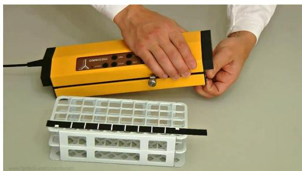
**Figure 3.2-2** Extraire le support de la bande X de l'unité de commande de l'OMNICOLL comme visualisé sur la figure.
