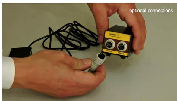
**Figure 1.3-4** Connecter l'alimentation électrique à la prise 'POWER' du module de communication.
