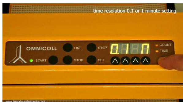
**Figure 3.4-8** Utiliser le bouton **SELECTION** (sous les Leeds COUNT/TIME) pour sélectionner "0.1M" correspondant à une résolution de 0.1 minute ou "1M" correspondant à une résolution de 1 minute
