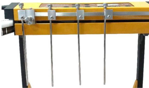
**Figure 3.8-9** Faire glisser les guides de tuyau dans leurs supports tout en préservant une certaine hauteur par rapport aux tubes dans les portoirs.
