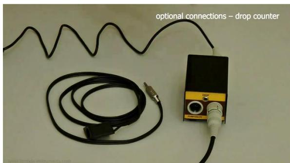
**Figure 1.3-1** Le compteur de gouttes (partie détecteur) connecté à son câble et le module de communication (Nr. Art. 6929)
