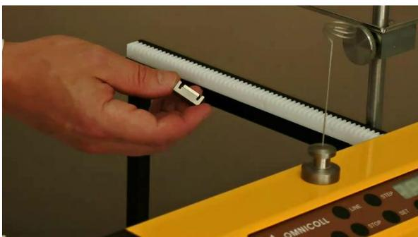
**Figure 1.1-11** Placer l'aimant qui sert de butée sur le côté interne du cadre de droite.
