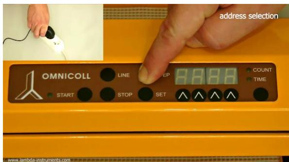
**Figure 3.4-14** Connecter l'alimentation électrique tout en appuyant sur le bouton **STEP**.
