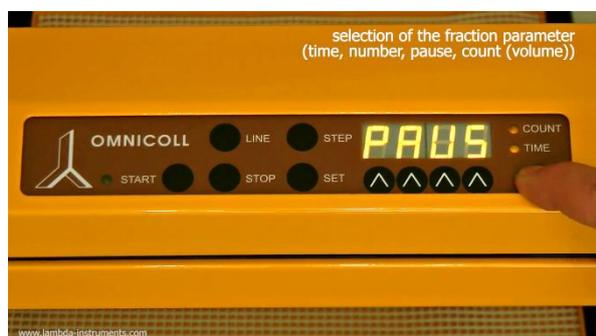
**Figure 3.7-6** Sélection du paramètre **PAUSE**, durée de la pause entre 2 échantillons.
