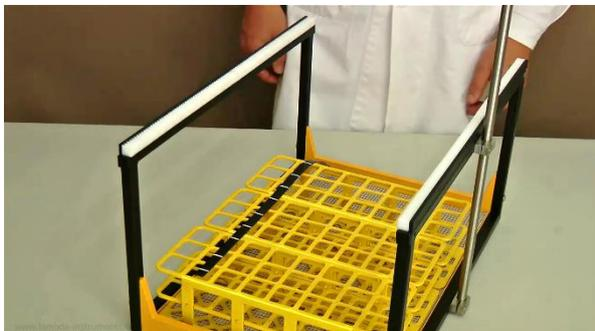
**Figure 3.3-5** Marquer la position des rangées à l'aide d'un stylo sur la bande de codage pour l'axe Y puis tracer les traits blancs avec le stylo de correction fourni.
