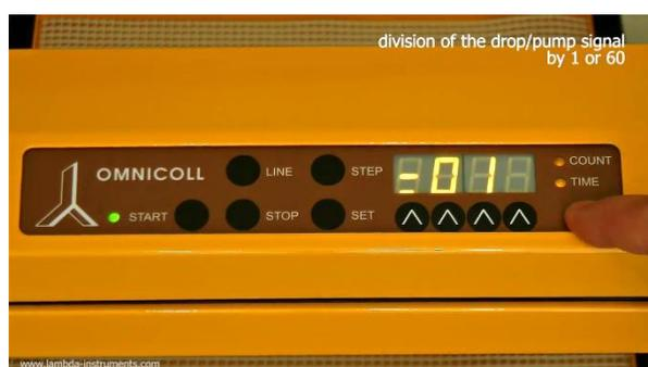
**Figure 3.4-12** Le bouton sous les Leeds **COUNT/TIME** permettent de sélectionner le facteur souhaité.
