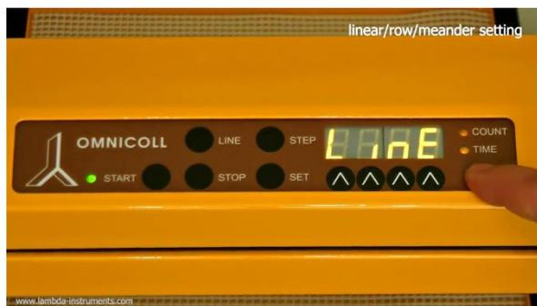
**Figure 3.4-4** "*Line*" pour le mode de déplacement en rangées.
