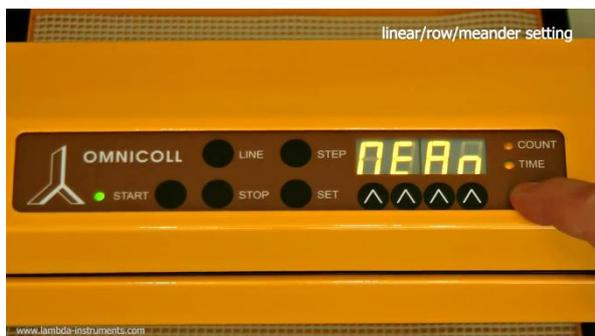
**Figure 3.4-3** "*Meany*" pour le mode de déplacement en méandres.
